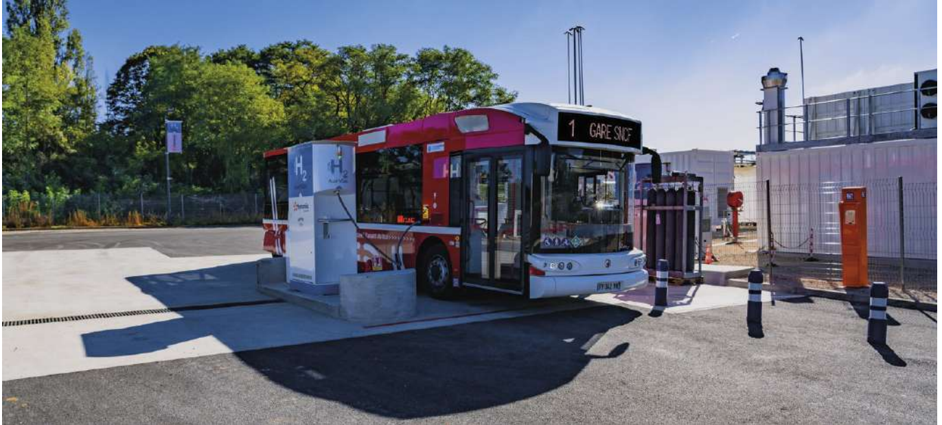
Projet « AuxHYGen » : station hydrogène bas-carbone pour bus en France (400 kg d'hydrogène/jour, 1 MW d'électrolyse), alimentant 5 bus.
