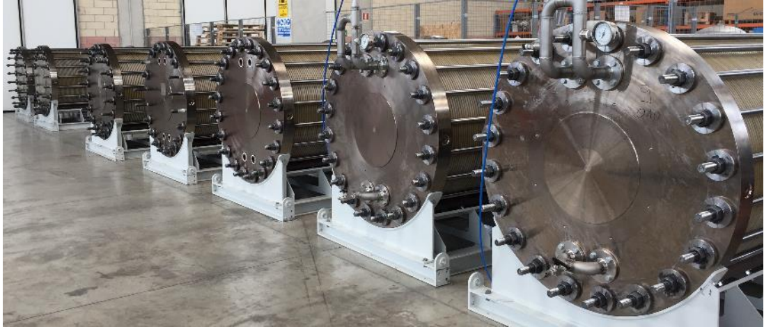
4 MW d'électrolyse pour un projet Power to Gas dans la province du Hebei en Chine
